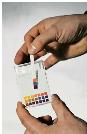
Bild 7 • Ein Vor-Ort- Schnelltest zeigt grob wo der pH-Wert liegt
