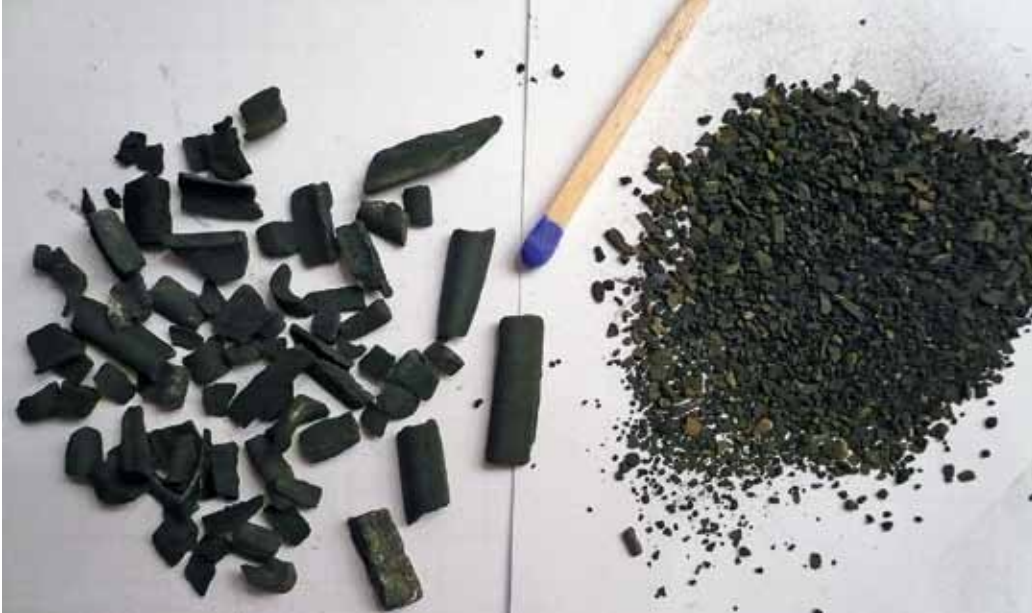
Solche groben Korrosionspartikel können zu Störungen an Pumpen und Thermostatventilen führen (links vor, rechts nach der Behandlung mit einem Reinigungs- und Dispersionskonzentrat).
